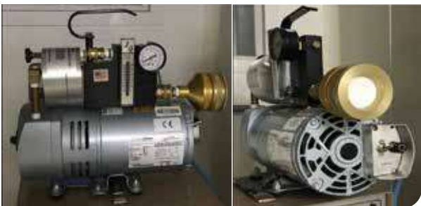
รูปที่ 6 แสดงอุปกรณ์เก็บตัวอย่างอากาศภายในห้องผลิตสารไอโซโทปรังสี (Air Sampling Pumps)
