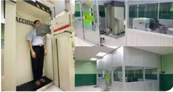
รูปที่ 8 แสดงเครื่องและห้องปฏิบัติการ Whole Body Counter สำหรับการตรวจวัดปริมาณรังสีภายในร่างกายและต่อมไทรอยด์
