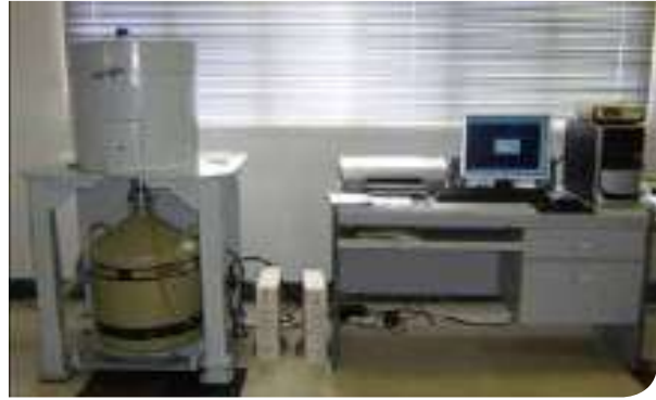
รูปที่ 7 แสดงเครื่องวัดรังสีแกมมาสเปกโตรเมตรี แบบเจอร์มาเนียมบริสุทธิ์สูง (HPGe)
