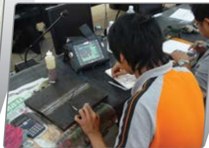
การตรวจสอบโดยวิธีใช้ คลื่นเสียงความถี่สูง
