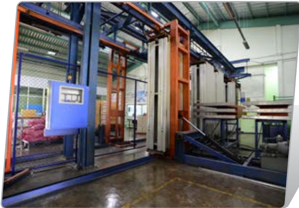
ภาพแสดงเครื่องฉายรังสีแกมมาโคบอลต์-60
