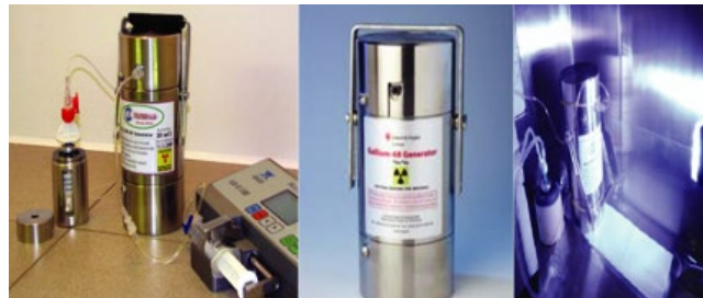
Fig.1 68 Ge/ 68 Ga Generator (Eckert & Ziegler)
