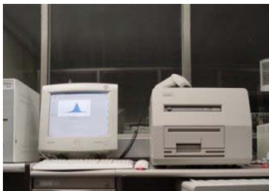
รูปที่ 3 แสดงอุปกรณ์เครื่องตรวจวัด TL และจอแสดงผลสัญญาณ Glow Curve
